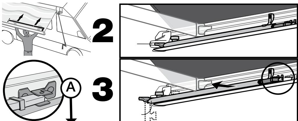
**DE** **Achtung Sicherheit.** Das Endstück des Stützfusses (A) wurde so entwickelt, dass ein falsches Positionieren in der Frontblende (wodurch sich die Frontblende nicht korrekt schließen würde) während der Markisenschließung verhindert wird; es wird daher empfohlen, dieses auf die richtige Art und Weise, mit der Basis zur Front hin, zu positionieren.
