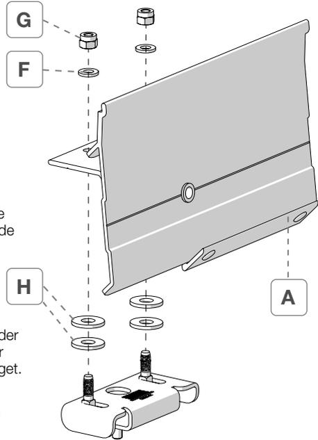
**NL** De borgringen "H" mogen alleen gebruikt worden indien noodzakelijk, om een te grote afstand tussen het dak van het voertuig en de beugel te compenseren.
