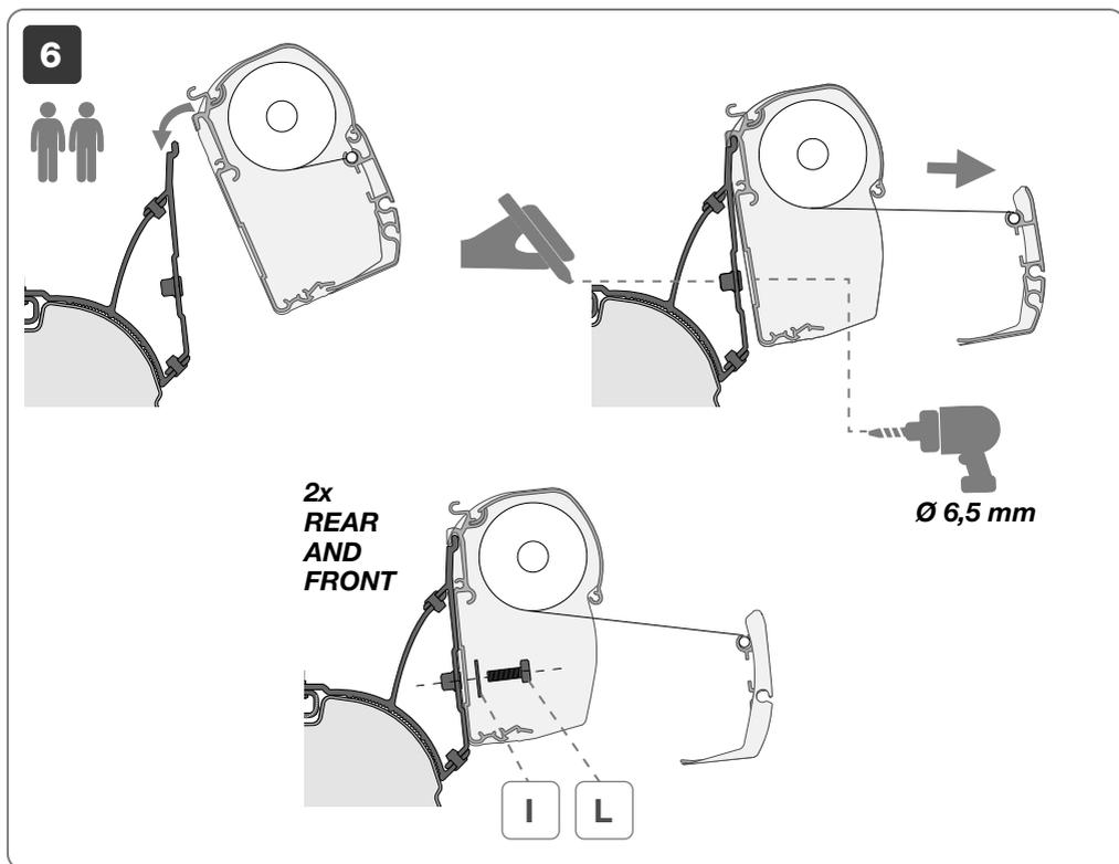
**NL** Voordat u de schroeven aandraait, moet u de positie van de luifel controleren zodat de achterklep volledig kan worden geopend.
